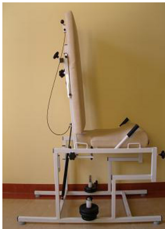
Rycina 1. Stanowisko badawcze przygotowane do badania w pozycji siedzącej.
